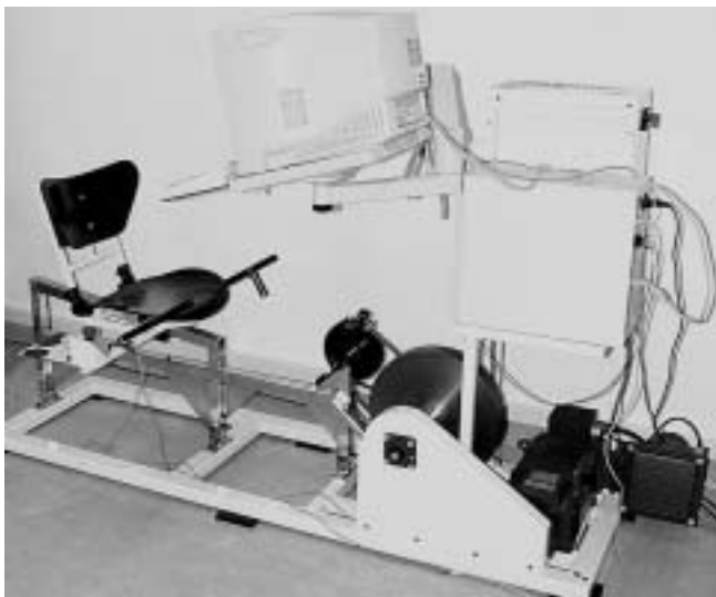
Abbildung 2: Gesamtansicht des «Eccentric-Trainers». Durch einen Elektromotor werden die Pedale angetrieben. Der Athlet sitzt wie auf einem Liegevelo und bekommt über ein computergesteuertes «Feedback-System» Auskunft über die Qualität der exzentrischen Beinmuskularbeit.
